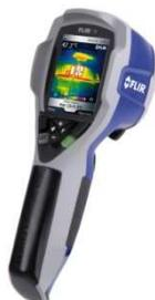
Una termocamera ad infrarossi è dunque un dispositivo senza contatto che rileva l'energia all'infrarosso (calore) emessa da un oggetto e la converte in un segnale elettronico che viene successivamente elaborato per produrre un'immagine termica su un display; è inoltre in grado di eseguire i calcoli della temperatura.
